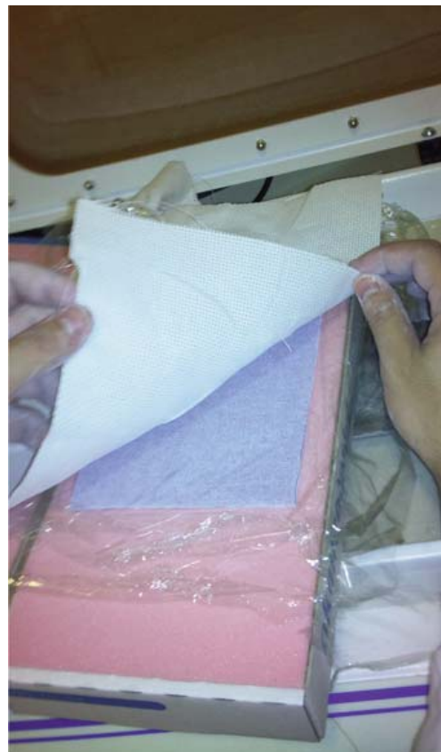
Fig 4 - Resina envuelta entre plásticos. Colocación del algodón para protección.
