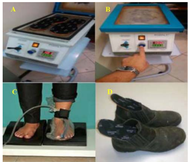
Figura 2: (2-a) Inserción de las plantillas en la máquina termocoladora; (2-b) termocolling; (2-c) moldura en el pie del individuo; (2-d) inserción de las plantillas en el calzado.
