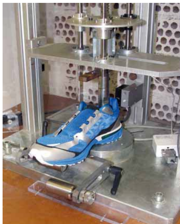
Figura 7. Ensayo de absorción de impacto con la máquina LecCus/IBV®
